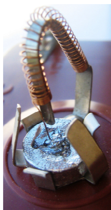
รูปที่ 10 อุปกรณ์ตรวจจับสัญญาณวิทยุยุคบุกเบิก ตัวตรวจจับหนวดแมว (ที่มา https://en.wikipedia.org/wiki/Crystal_detector )
