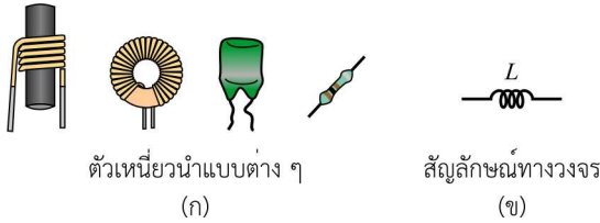
รูปที่ 2-11 (ก) ตัวเหนี่ยวนำแบบต่าง ๆ และ (ข) สัญลักษณ์ทางวงจร
