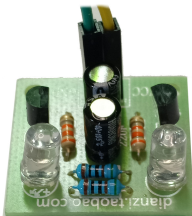
รูปที่ 4 ตัวอย่างภาพวงจรไฟกระพริบบนแผ่นวงจรพิมพ์หลังบัดกรีเสร็จแล้ว
